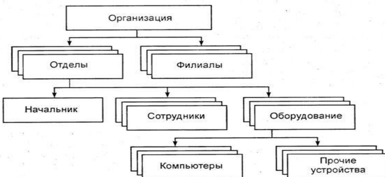
Рисунок 1. Иерархическая древовидная структура модели БД Источник: [2]
